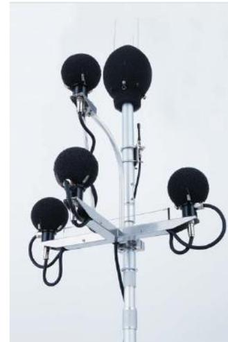
Antenne acoustique détermination de la direction de provenance du bruit
